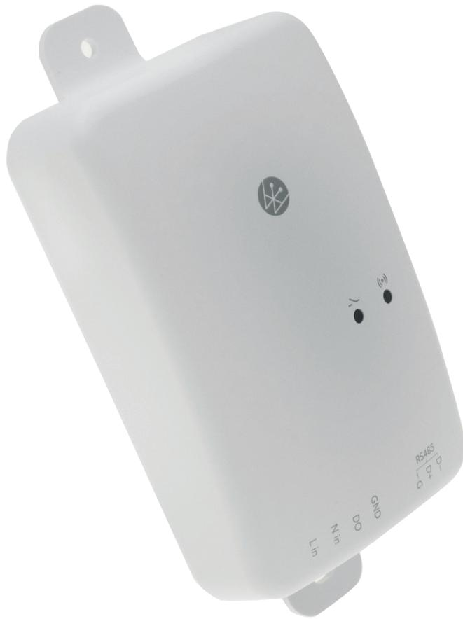
CV1602属于iCube系列产品，用以转换设备端输入和输出讯号，将有线RS-485讯号转换成无线ZigBee讯号，也可将无线ZigBee无线讯号转换为有线RS-485讯号，不需要解译通讯格式即可完整传送讯号。适用于具改装需求的案场，减少拉线施工及维护成本，而对于监测系统网路布建，提供可弹性的选择。
