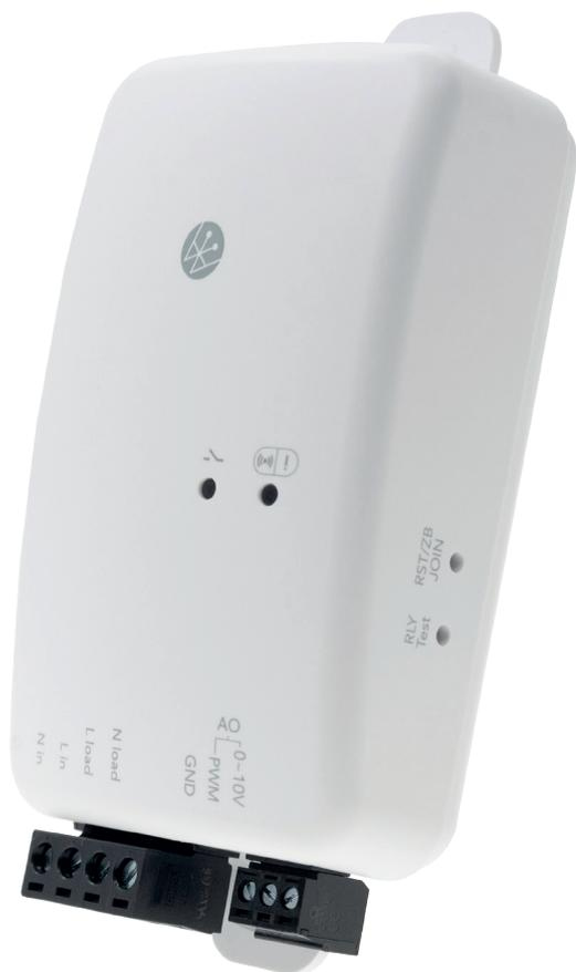
CR2050属于iComm系列产品，用以控制区域内所有LED灯具照明，对建筑物内各个区域的光线感测设备所获得的数据进行分析处理，并且将开关功能与调光功能结合为一，内建负载电力资讯搜集功能提供耗电量资讯，将数据资料经由ZigBee无线方式传递至逻辑控制器进行演算，优化建筑物内照明输出明亮度，达成能源最佳化运用。
